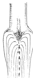
図6. 入り皮の又は材がつながって入り両側面が耳形に張り出す
