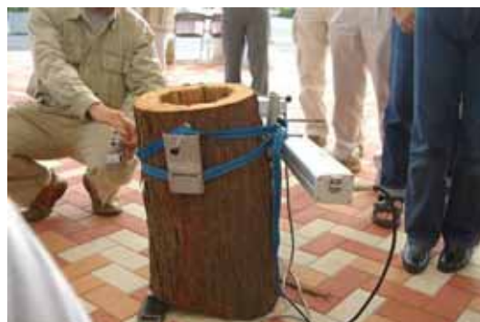
線樹木腐朽診断器による樹木診断
